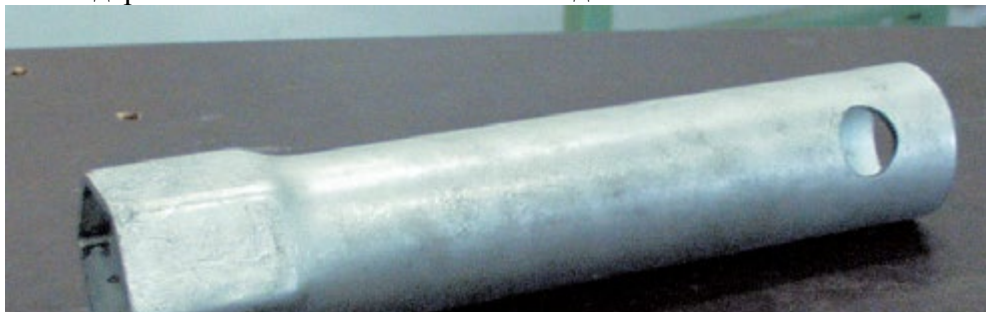
Рисунок 10 – Универсальный ключ для настройки регуляторов давления газа серии HON330 (заказной № 00 02 65 02)
